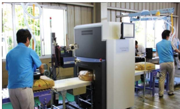
写真4 全袋検査をする放射能測定装置 (JAみちのく安達での装置設置・検収作業)
