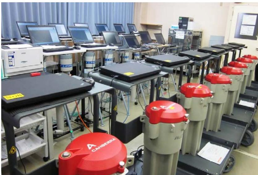
写真3 JA 新ふくしま・矢野目モニタリングセンターに設置されているNaI(Tl)シンチレーションスペクトロメータ(32台)の一部
