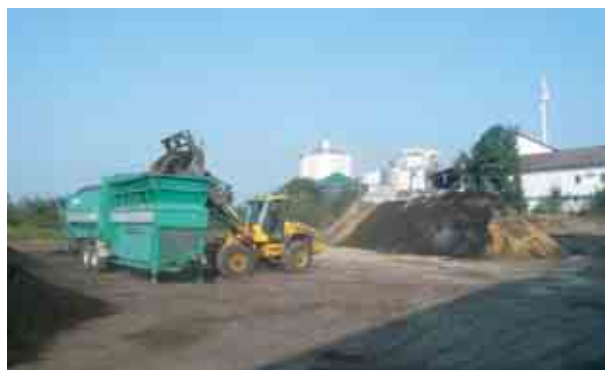
草木堆肥場。二次発酵後、機械で土粒状に成形
