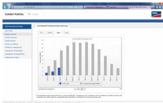
PC画面での遠隔監視による日常メンテナンス（SMA社HPから）
