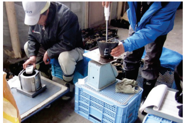
写真3 丁寧・慎重な放射線量の測定作業
