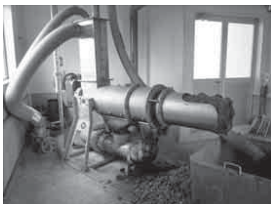
写真1 固液分離機(筆者撮影, 以下同じ)
