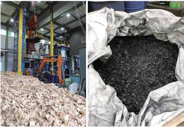
南部町木質バイオマスガス化発電所のガス化炉とバイオ炭(写真：(株)長大提供)
