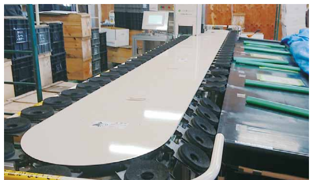
写真2 当社の光センサー選果機(長さ6m×幅1.8m)(撮影:農林中金総合研究所)
